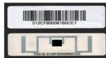
Fig -4: RFID tag.
